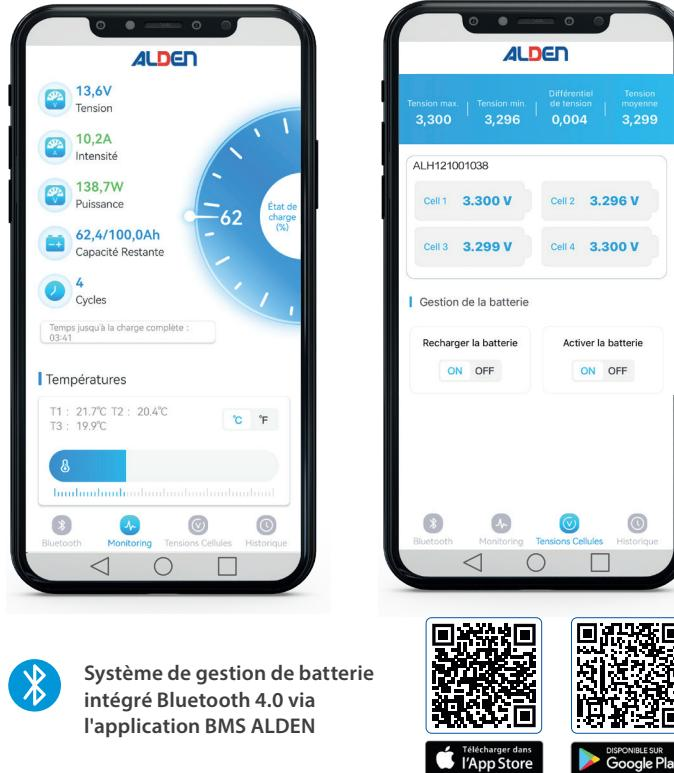
\*Le Smart BMS (Smart Battery Management System), ou système de gestion de batterie, permet la surveillance (Bluetooth 4.0 intégré), la protection et la gestion de divers paramètres de la batterie afin d'optimiser ses performances, de prolonger sa durée de vie et de garantir la sécurité de son utilisation via votre smartphone ou votre tablette. L'application Solarwatt Alden affiche les données en temps réel. Disponible sur Apple Store et Google Play.
