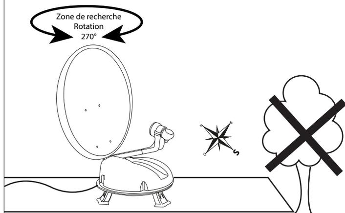
Déposer votre antenne satellite portable VANSAT sur une surface plane et stable à même le sol. Orienter approximativement votre antenne vers le Sud. La zone de recherche s'effectue sur 270°, assurez-vous qu'aucun obstacle ne se trouve à proximité de l'antenne.
