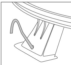
Insérer les 3 piquets en acier à chaque pied de l'antenne pour lui permettre une meilleure stabilité.
